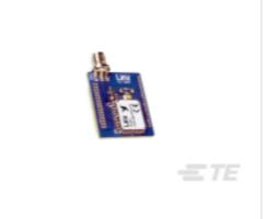
TE Part #EVM-868-PRC-CAS Eval-Module HUM-PRC 868MHz FHSS XCVR CAS
