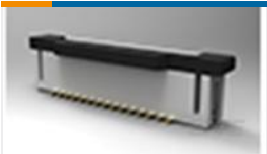
TE Part #1-1734248-3 1.0 FPC, ZIF V/T, SMT, 13P
