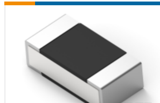
TE Part #5-2176305-1 RP 1E 0.1W 357R 0.1% 25PPM 5K RL
