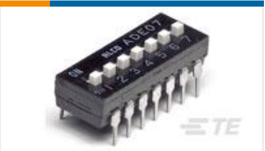
TE Part #1825057-7 ADE0804=DIP SWITCH,EXT,THRU/HL
