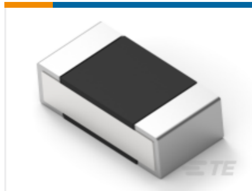
TE Part #6-2176307-8 RP 1E 0.1W 61K9 0.1% 25PPM 5K RL
