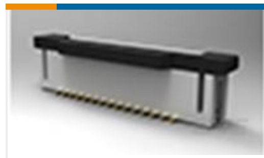
TE Part # 1-1734248-5 1.0 FPC, ZIF V/T, SMT, 15P
