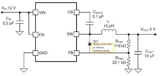
Figure 9-2. Replacing Non Sync Converter
