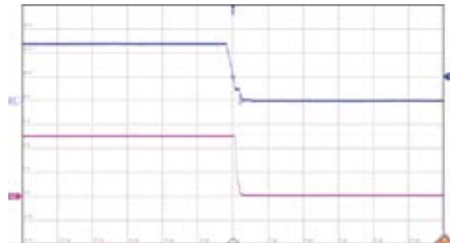
Ch1: Input voltage (10 V/div.) Time scale: (2 ms/div.) Ch2: Output voltage (2 V/div.)
