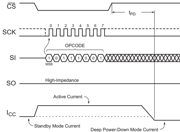
Figure 24. Deep Power-Down Sequence Diagram
