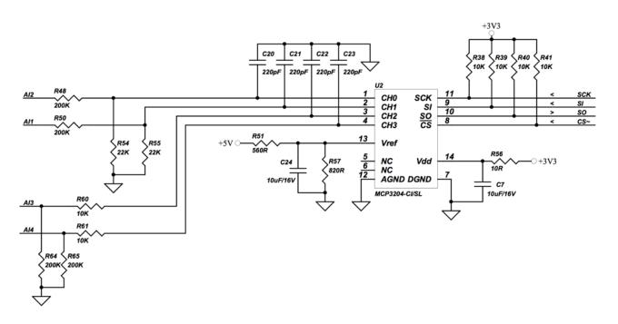
THE IONO PI A/D CIRCUIT
