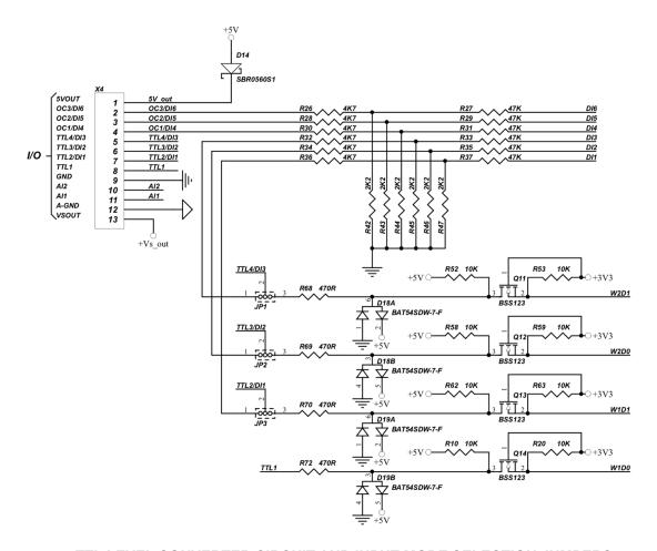
TTL LEVEL CONVERTER CIRCUIT AND INPUT MODE SELECTION JUMPERS
