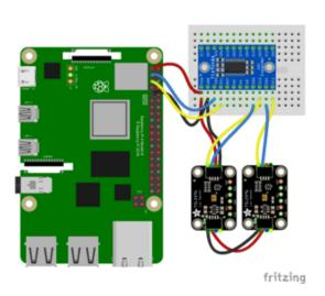
Pi 3V to mux VIN (red wire)
