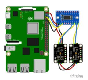
Pi 3V to mux VIN (red wire)
