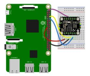
Pi 3V3 to sensor VIN (red wire)
