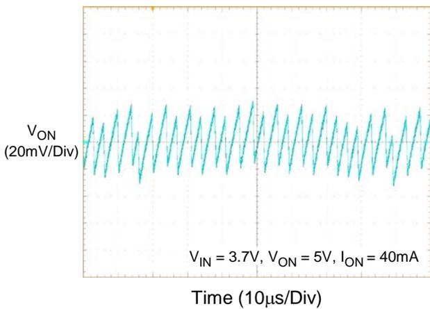
V<sub>ON</sub> Ripple Voltage
