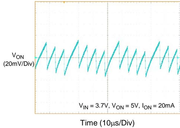
V<sub>ON</sub> Ripple Voltage
