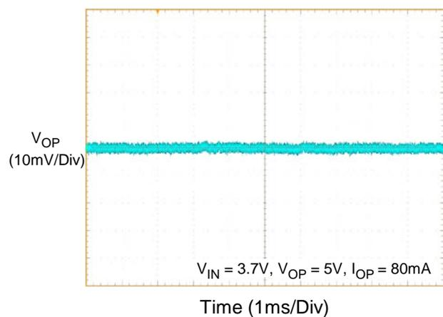
V<sub>ON</sub> Ripple Voltage
