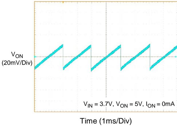
V<sub>ON</sub> Ripple Voltage
