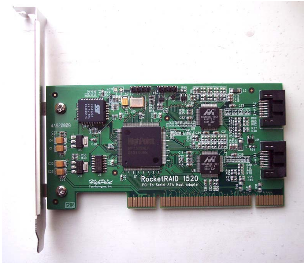
RocketRAID 1520 卡正面图
