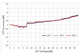
Figure 19. Attenuation Error : 3.6GHz
