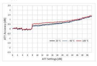
Figure 20. Attenuation Error : 4.0GHz
