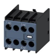
Auxiliary switch 11 U, on the front, 1 NO + 1 NC Current path 1 NO, --, 1 NC, -- for 3RH and 3RT screw terminal .7/.8, --/--, .5/.6, --/--
