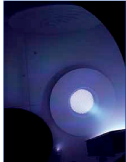
Ionenquelle eines Ionenstrahlverdampfers (Sputter)
