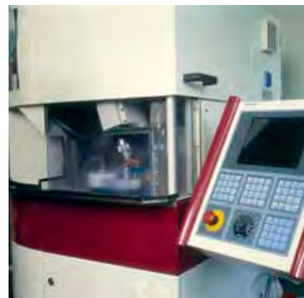
Optikfertigung mit CNC Poliermaschine Optics production with a CNC polishing unit
