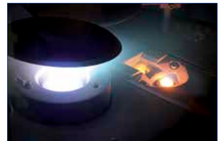
Beschichtungsanlage mit einem plasma-gestützten Elektronenstrahlverdampfer
